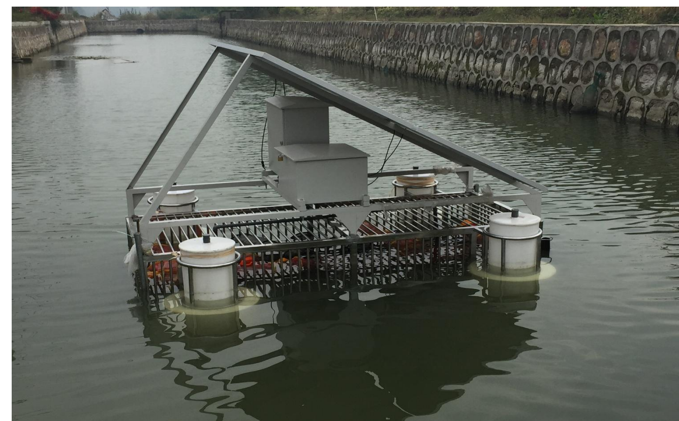
Fig.6 研发的新型生物膜原位修复装置
