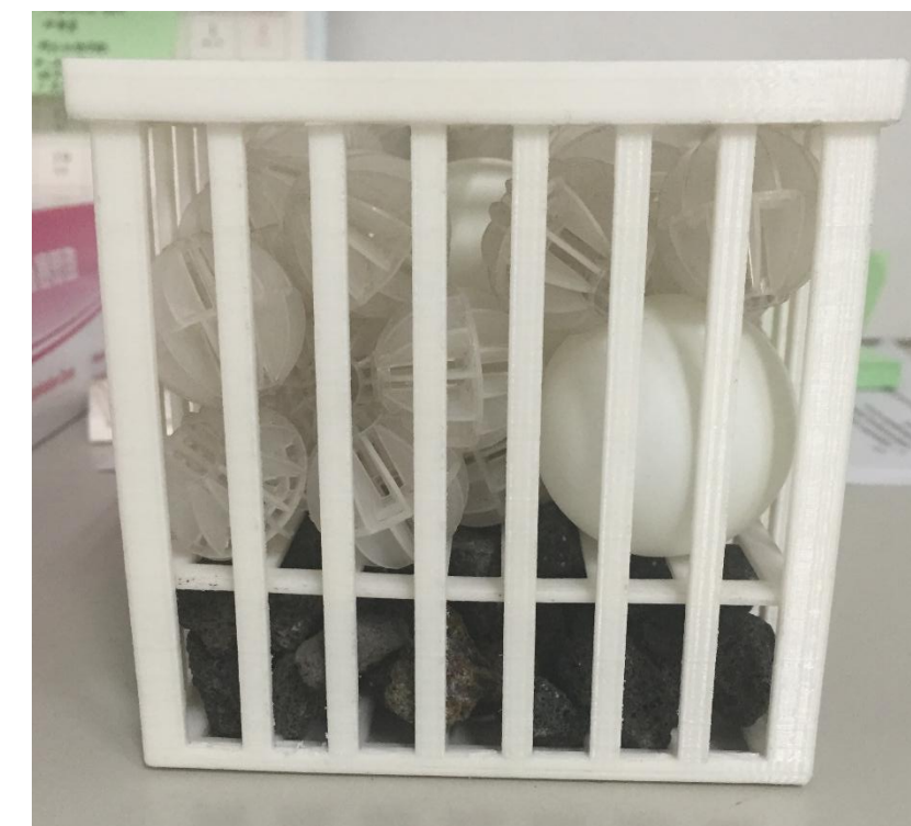
Fig.7 研发的适用于新型曝气浮岛的概念填料的雏形
