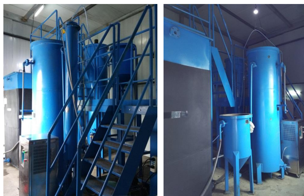
图2 发酵废水处理中试装置
