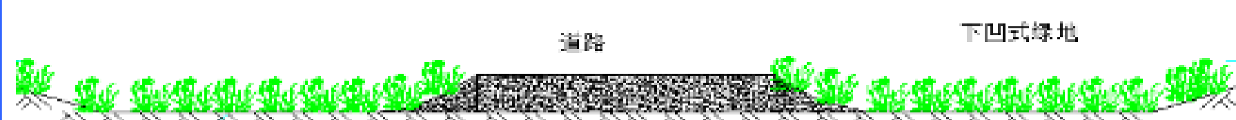
图6.道路雨水收集系统改造效果简图
