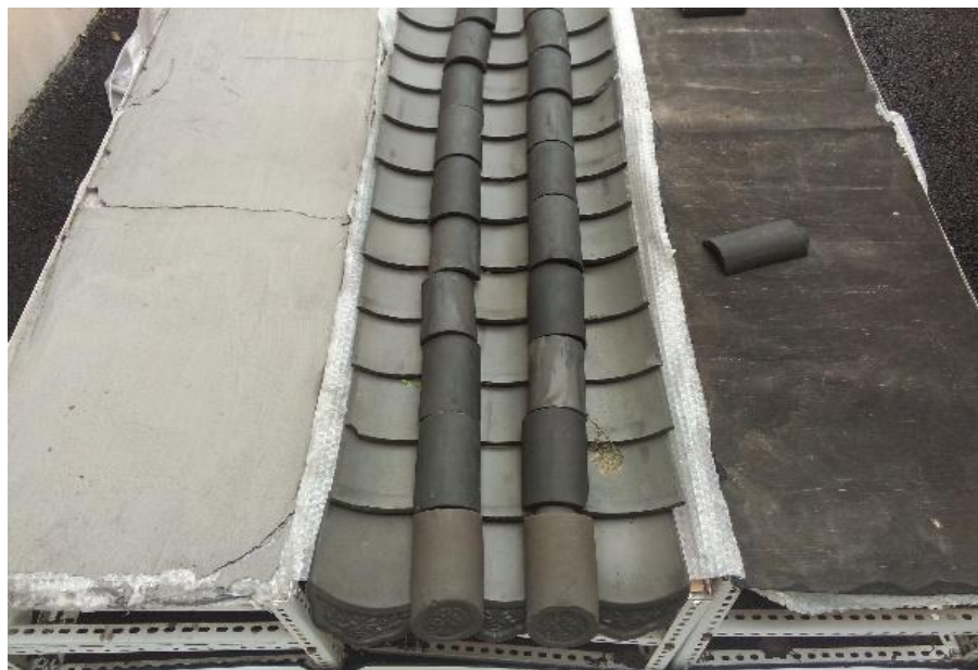
图1.屋面模拟径流实验装置
