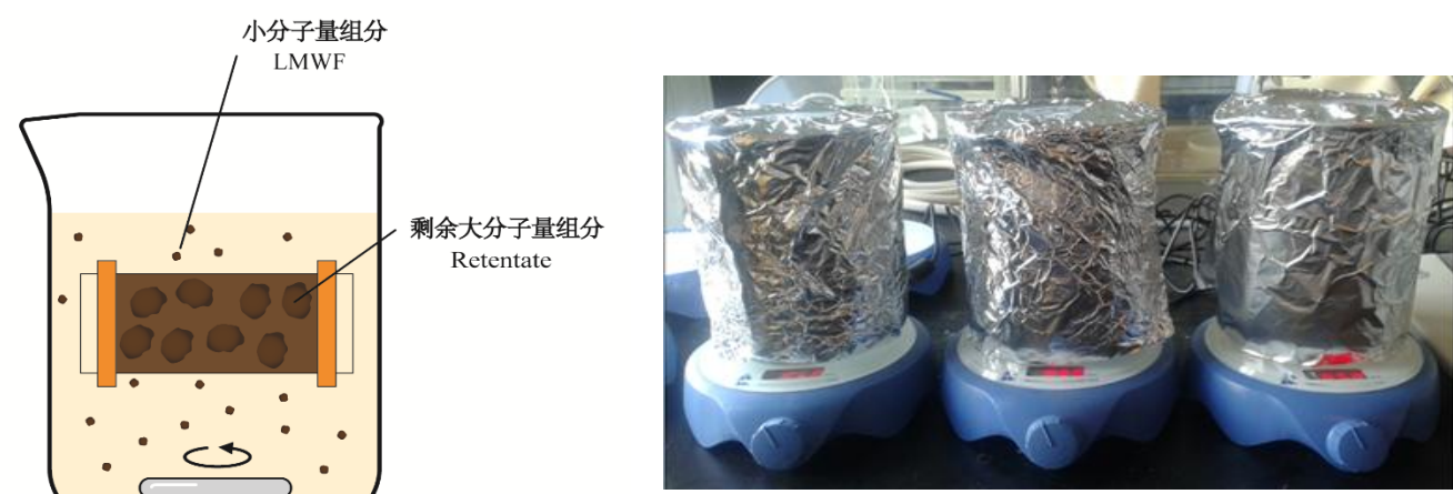
图1 腐殖酸分子分离透析装置
